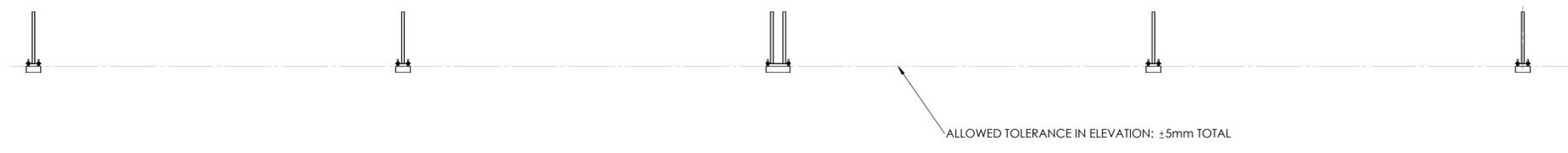
LONGITUDINAL ALIGNMENT OF DRIVE STAND STUDS
