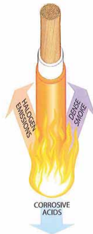
Non LSZH Cables
